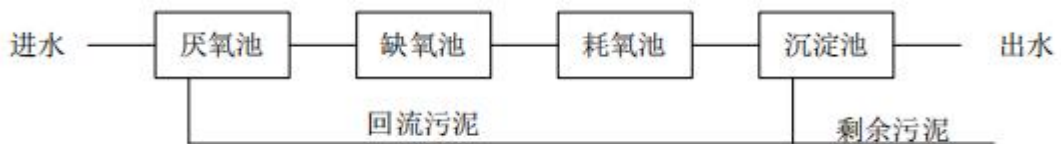
图 4-3 矿业机电产业园污水处理站处理工艺流程图
