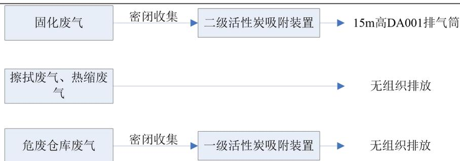
图 4-1 废气收集处理流程图
