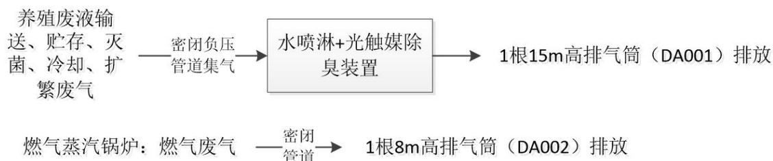
图 4-1 建设项目废气收集、处理方式示意图
